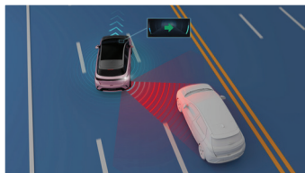
Lane Change Collision Warning (LCW) ระบบช่วยเตือนการชนเมื่อเปลี่ยนช่องทางเดินรถ
