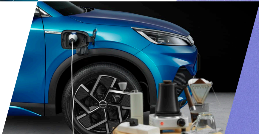
ฟังก์ชัน V2L (Vehicle to Load) สามารถต่อกระแสไฟ 220V จากรถยนต์ไปพ่วงใช้กับอุปกรณ์ไฟฟ้าอื่นๆ ได้
