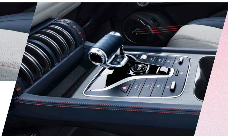
สวิตช์เปลี่ยนเกียร์แบบ Finger-touched Electronic Shift
