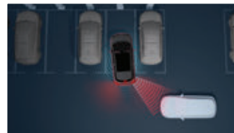
Rear Cross Traffic Alert and Braking (RCTA + RCTB) ระบบช่วยเตือนและระบบช่วยเบรกเมื่อมีรถผ่านในจุดอับสายตาทางทะเลยหลัง
