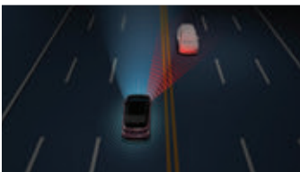
Adaptive Front Light (AFL) ระบบช่วยเปิด - ปิดไฟหน้าอัตโนมัติ
