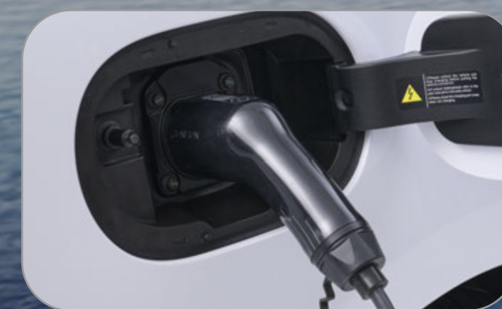
รองรับการชาร์จแบบ AC Type 2 กำลังสูงสุด 6.6 กิโลวัตต์
